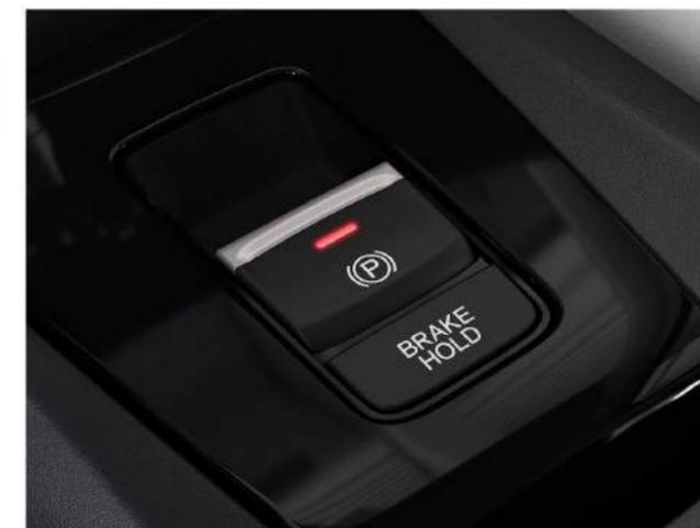
Freio de estacionamento eletrônico com função Brake-Hold
